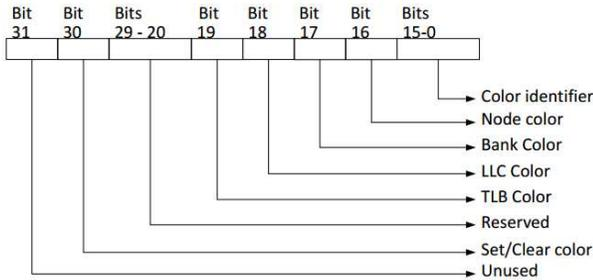
Fig. 6. `mmap()` color parameter bits identifiers
